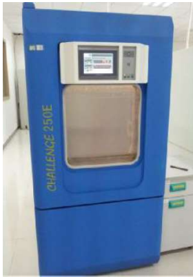
温度-湿度-振动综合环境试验箱 Temperature & Humidity Cycling &Vibration Chamber
