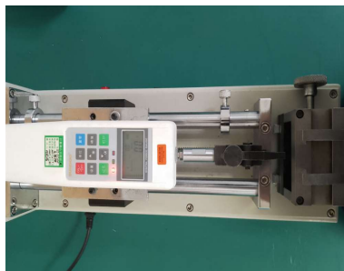
数显测力计 Ergometer
