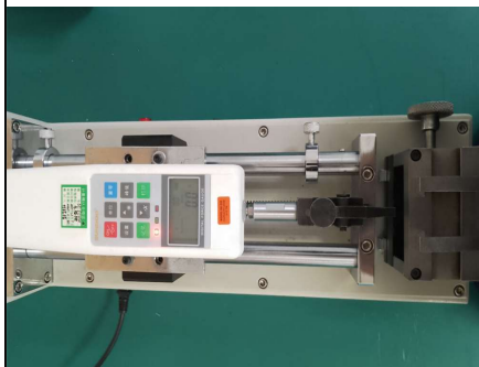
数显测力计 Ergometer
