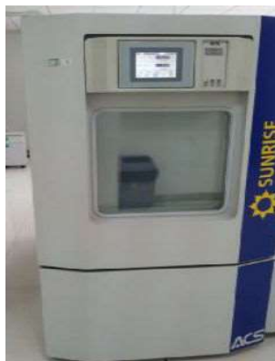
高低温湿热试验箱 Temperature & Humidity Cycling Chamber
