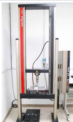
万能拉力试验机 Universal tensile testing machine
